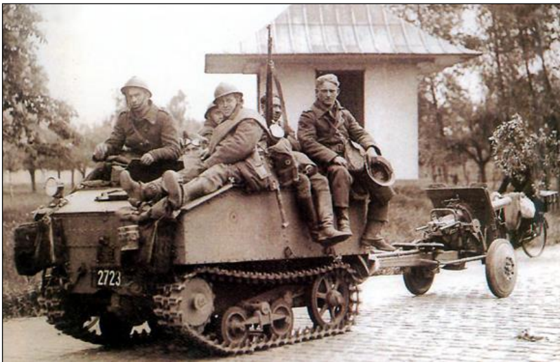
De Vickers utility tractor (VUT) werd in 1928 in het Verenigd Koninkrijk ontwikkeld als een kleine ongepantserde rupstrekker voor licht geschut. Vanaf 1936 werd onder licentie een versie in België gebouwd bij SA des Ateliers de Construction de et à Familleureux.
